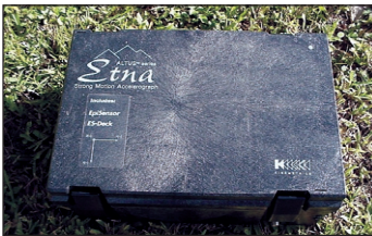
Fig. 37. Acelerógrafo usado en la Red Nacional Acelerográfica.
