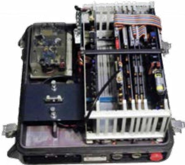
Aparato que permitía medir y registrar la aceleración del suelo en el sitio donde se encontraba instalado. En su interior se observan en la parte superior izquierda, tres acelerómetros: uno vertical y dos horizontales.
