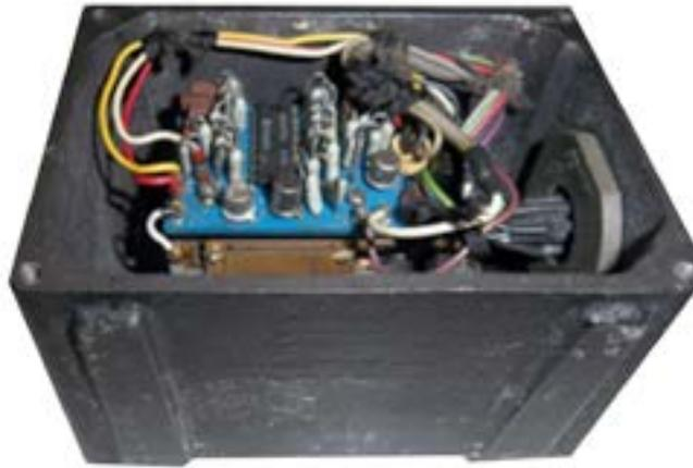
Nombre técnico: Acelerómetro uniaxial
