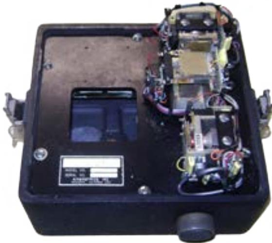
Equipo que se utilizó para medir la aceleración del suelo donde se encontraba instalado. El modelo mostrado estaba equipado con tres componentes. En la parte superior derecha se observa el acelerómetro transversal, seguido por el vertical en el centro y el sensor longitudinal ubicado en la parte inferior justo al lado del conector que permitía, a través de un cable, llevar estas señales hasta la unidad central de registro.
