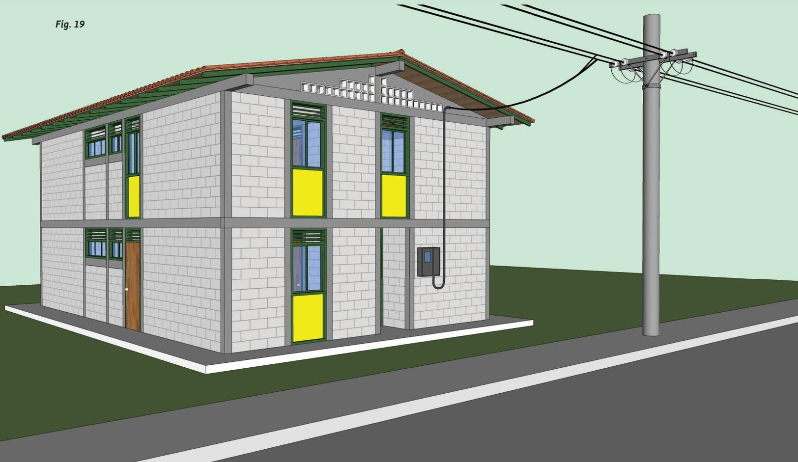
Figura 19. Vista de la acometida eléctrica desde la red de baja tensión del área urbana hasta la entrada al medidor de la vivienda.
