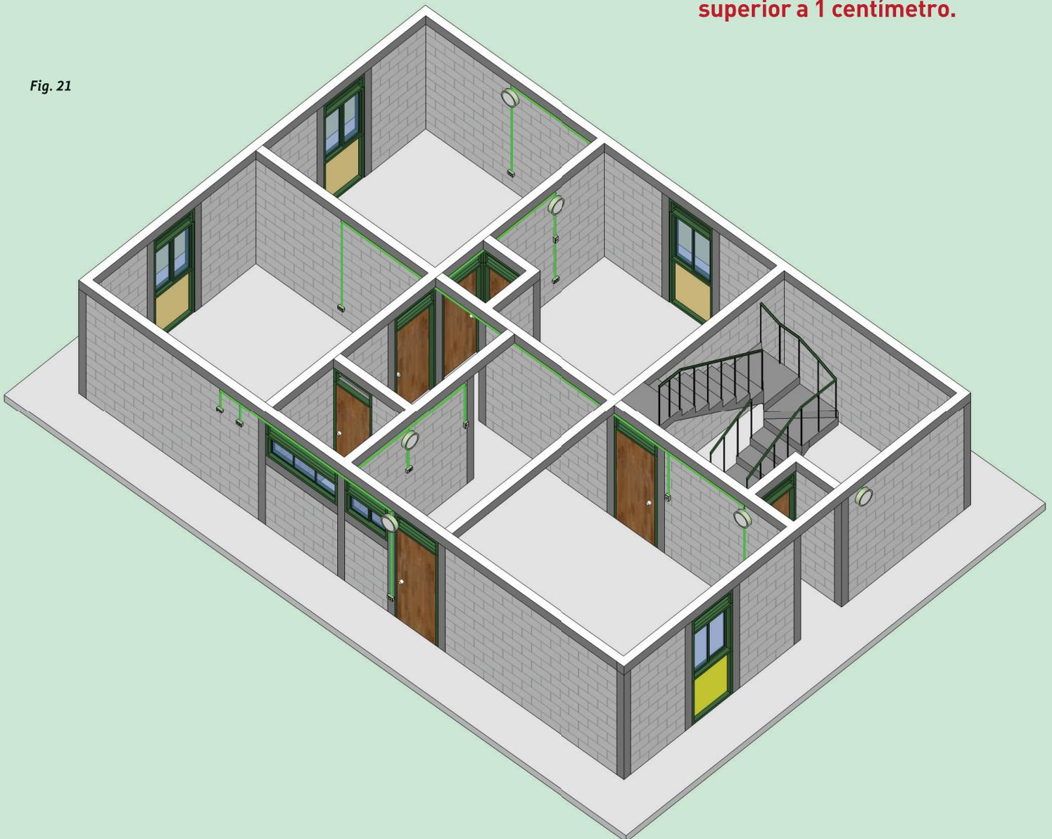
Figura 21. Axonometría de la instalación eléctrica.
