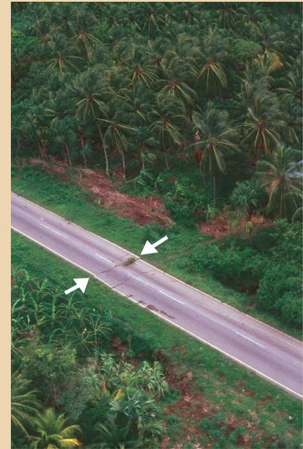
La fractura abierta con forma de S y el desplazamiento de la raya blanca en el borde de la carpeta asfáltica indican que la ruptura sísmica corresponde a un desplazamiento horizontal hacia la derecha en dirección al fotógrafo (Fotografías André Singer)
